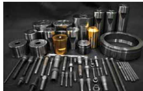
鍛造用金型と鍛造された製品例
