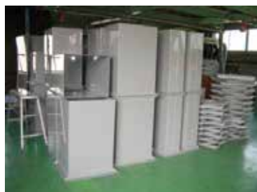
排気ダクト（角形）
