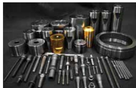
鍛造用金型と鍛造された製品例
