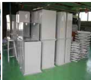
排気ダクト（角形）
