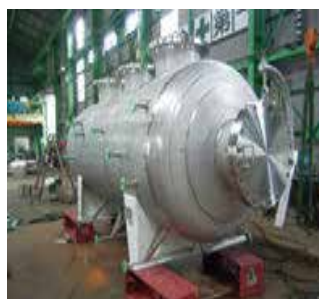
SUS製圧力容器 JX日鉱日石石油基地殿向
