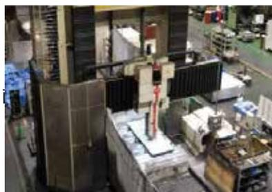
大型五面加工機 (新日本工機 HF-6M)
